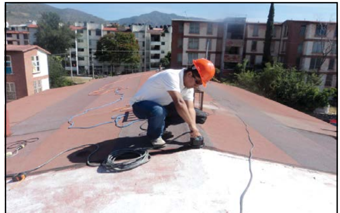
Figura 8. Obtención de registros acelerográficos de la unidad habitacional INFONAVIT.
