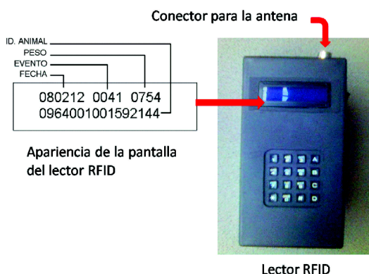
Figura 2. Lector y apariencia de la pantalla del prototipo de identificación animal
