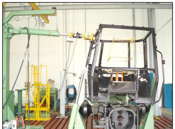
Figura 9: Ensaio de carregamento lateral. (fonte: AGCO do Brasil)
