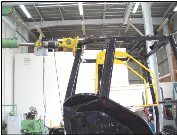
Figura 5: Ensaio de carregamento lateral. (fonte: AGCO do Brasil)
