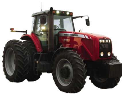
Figura 2: Trator Massey Ferguson cabinado com ROPS de seis postes. (fonte: AGCO do Brasil)
