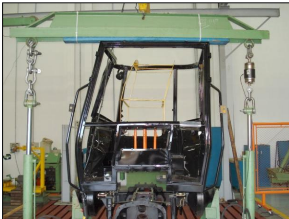
Figura 11: Ensaio de esmagamento das colunas dianteiras. (fonte: AGCO do Brasil)
