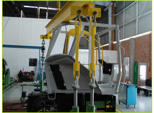
Figura 7: Ensaio de esmagamento das colunas dianteiras. (fonte: AGCO do Brasil)
