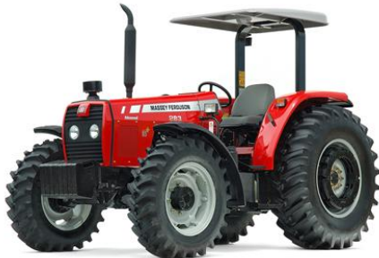
Figura 1: Trator Massey Ferguson plataformado com ROPS de dois postes. (fonte: AGCO do Brasil)
