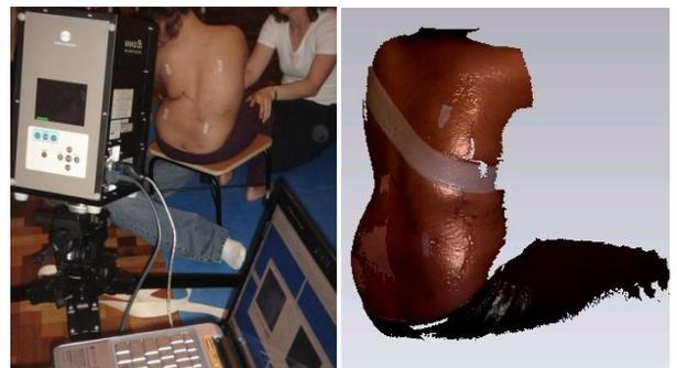
Figura 7 – Digitalização para projetar encosto personalizado: (a) Scanner 3D adquirindo dados e (b) modelo 3D obtido.
