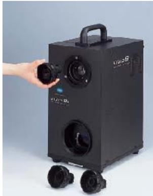
Figura 1 – Scanner 3D Móvel - Vivid 9i.
