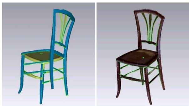
Figura 10 – Modelos virtuais da cadeira para análise: (a) modelo adquirido por digitalização tridimensional e (b) modelo final renderizado.
