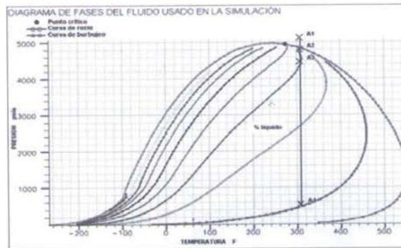
Figura 1. Diagrama de fases de una mezcla gas-condensado.
