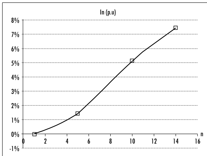
Figura 10. Remanente de la corriente de secuencia negativa una vez eliminada la componente de desequilibrio de tensión y la corriente inherente a la asimetría del motor vs. nivel de falla (n)
