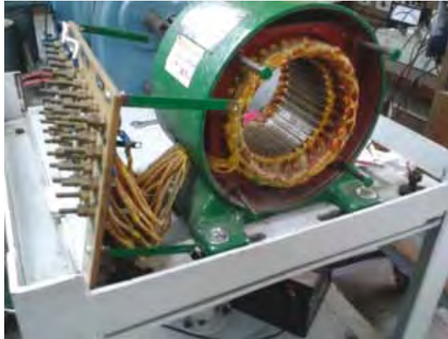
Figura 3. Vista lateral del bobinado del motor con los terminales insertados para hacer los corto-circuitos
