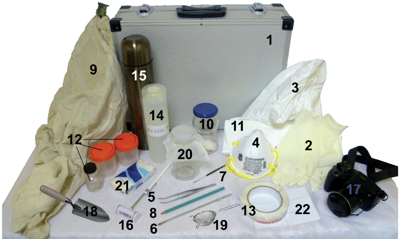
Fig. N° 2. Kit de material para toma de muestras entomológicas. 1 Caja o bolso para el transporte del equipo, 2 Guantes, 3 Tyvek, 4 Mascarilla, 5 Pinzas de punta fina, 6 Cucharas para recoger gusanos, 7 Pincel (número 2 o similar), 8 Lápiz de grafito, 9 Red de tela suave, 10 Frasco de vidrio con algodón con Éter etílico, 11 Algodón, 12 Frascos plásticos, 13 Cinta para sellar los frascos, 14 Recipiente con etanol de 70° de 1000 ml, 15 Termo con agua caliente (mayor a 70° C), 16 Termómetro, 17 Cámara de fotos, 18 Pala de jardinería, 19 Tamiz, 20 Frasco con Tela "voile", 21 Papel tisú, 22 Papel vegetal para etiquetas.
