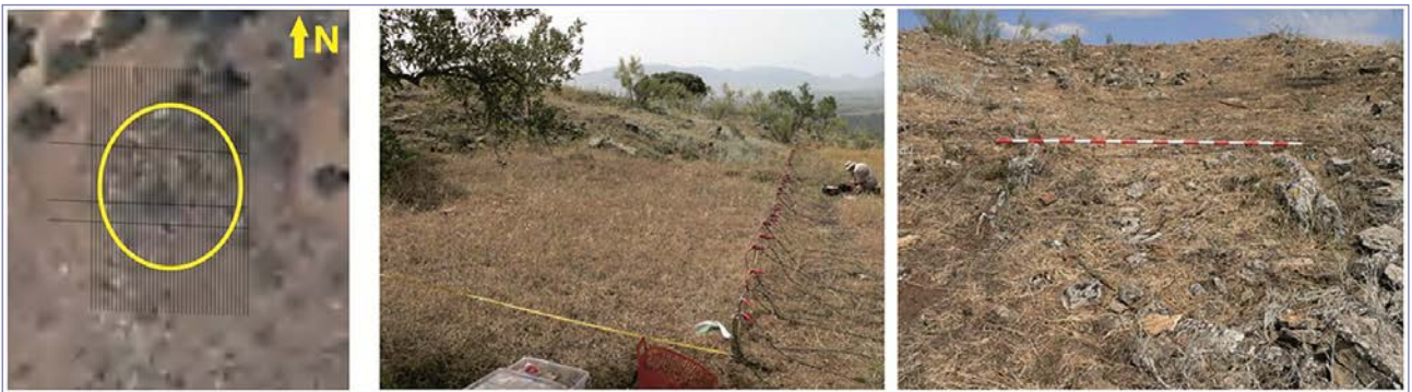
Fig. 3. Emplazamiento de los perfiles eléctricos en la zona de estudio, el círculo amarillo marca la elevación a investigar. (b) Vista general de la adquisición de un perfil eléctrico. Las medidas de resistividad aparente se realizaron con un equipo de tomografía TERRAMETER LS-12 (ABEM; Inc.). (c) En superficie se observan las caras superiores de lo que aparentan ser dos ortostatos paralelos pertenecientes al corredor de acceso, su orientación ha determinado el trazado de los perfiles eléctricos.
