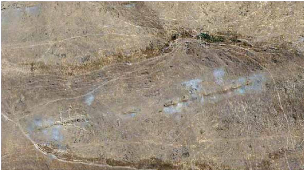
*Fig. 1. La aplicación de criterios visuales permite identificar en esta imagen varios elementos. Por ejemplo, la textura característica del río y su asociación con zonas deprimidas topográficamente, reconocidas por las sombras, criterio que también se reconoce en los rafados y las trincheras, elementos donde además la tonalidad es muy característica. (detalle de imagen PNOA)*
