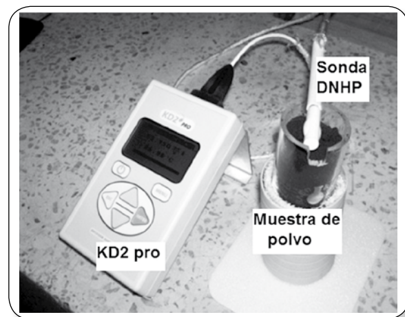
Figura 1. Montaje experimental del Sistema KD2-Pro.
