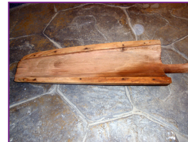
5. Galápago para curvar la lámina de barro obtenida con la gradilla y obtener la curvatura de la teja
