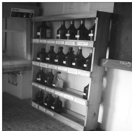
Figura 2. Estante para segregación de residuos químicos Fuente. Los autores
