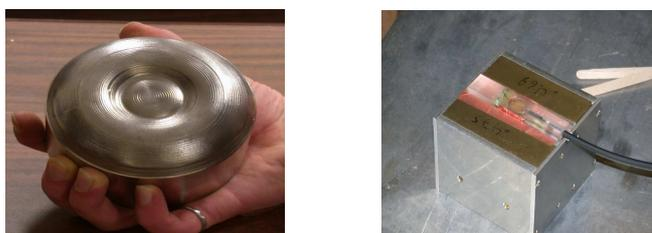
Fig. 4. Imanes unilaterales diseñados en el Centro de Resonancia Magnética de Imágenes de la Universidad de New Brunswick.
