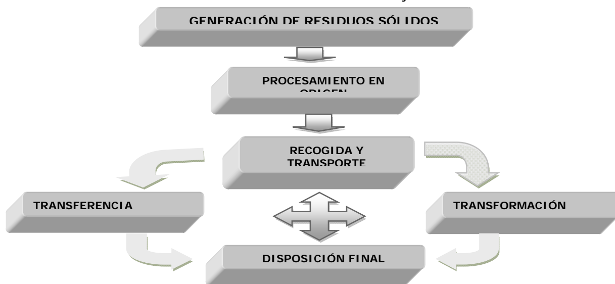
Figura 2. Interrelación de los elementos funcionales del manejo de los residuos sólidos Fuente: Tchobanoglous, Theisen y Vigil, 1998
