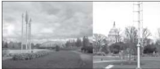
Fig. 2. Turbinas eólicas de eje vertical para PMSG
