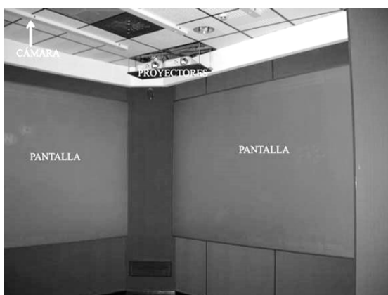
Figura 4. Una esquina del montaje hardware donde se pueden ver los elementos más importantes del mismo
