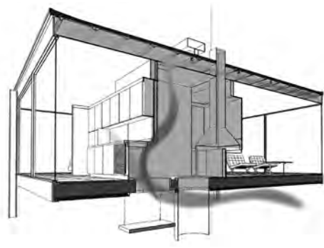
Figura 5. Simulación del sistema pasivo de enfriamiento de la casa. Modelo. Fuente: los autores
