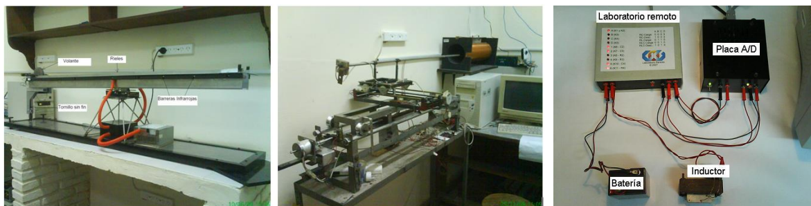
Figura 1: De izquierda a derecha: experiencia de plano inclinado con volante, experimento de solenoide con brazo robótico y experimento de circuitos eléctricos en régimen transitorio.
