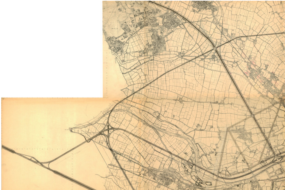
Figura 4. Montaje de varias de las hojas a escala 1:4.000 correspondiente al sector Noroeste del término de Valencia, en la que se recoge, sobre la base catastral, la solución viaria de García-Ordóñez para Valencia. Las hojas no llevan fecha ni firma, pero hay que datarlas sin duda hacia 1959.
