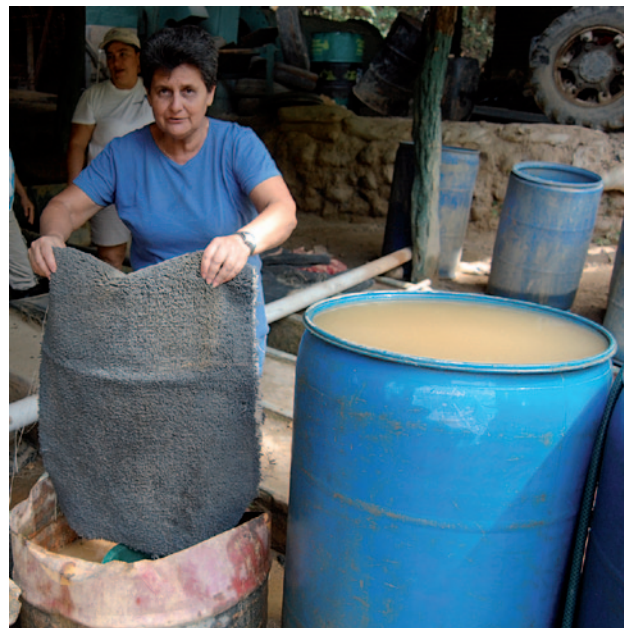
Figura 7. Lavar las lamas o barro con el material amalgamado. Fotografía: G. Villalobos.
