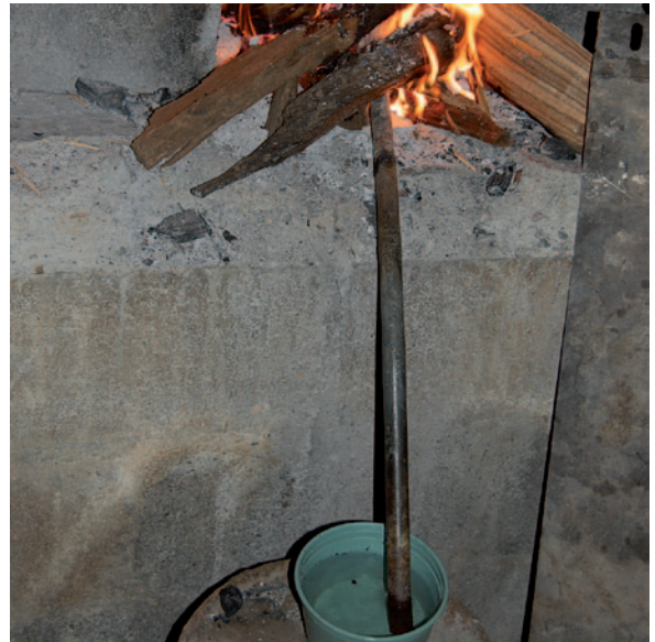
Figuras 8 y 9. Separación de oro del mercurio por medio de evaporación, para lo que se utiliza la retorta. Fotografía: G. Villalobos.
