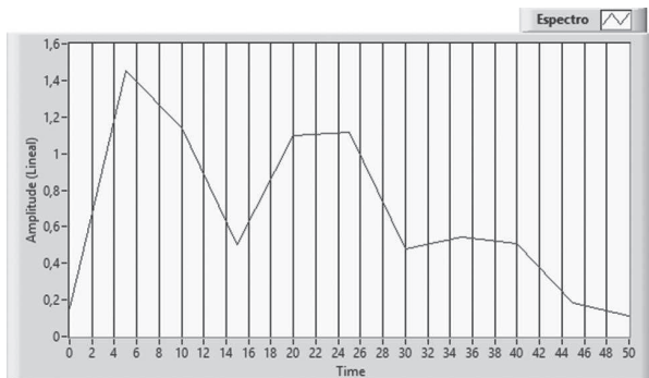
FIG. 4. Respuesta frecuencia viga en voladizo libre
