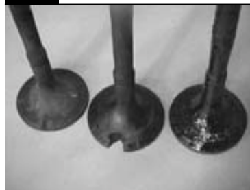
Foto 8. Depósitos en válvulas.
