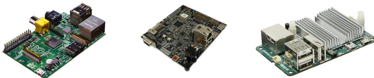
Figura 1. De izquierda a derecha: Raspberry Pi, PandaBoard y Odroid-U3
