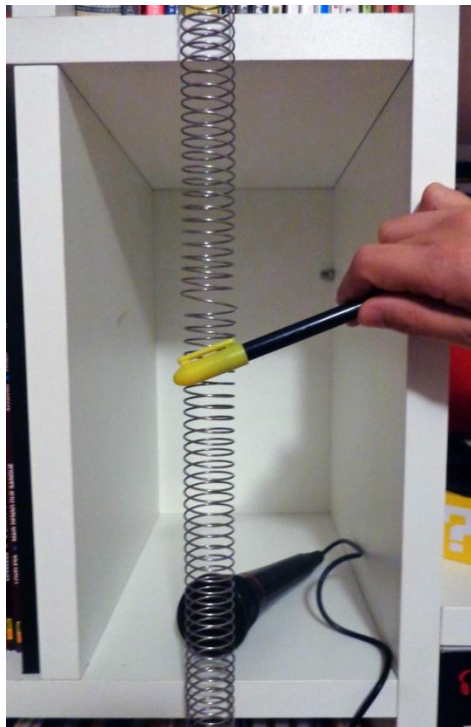
Fig. 1 – Montagem para se captar o efeito sonoro, segundo Micolich (2009).
