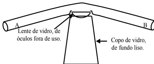
*Fig. 2 – O eletroscópio gigante completo (fora de escala). A parte móvel de eletroscópio tem seu centro de massa situado abaixo do ponto de apoio (a parte inferior da lente de vidro), o que permite o equilíbrio e a estabilidade mecânica do aparelho. O cano de PVC não deve tocar no copo.*
