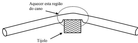
*Fig. 1 – A figura mostra o cano sendo dobrado. Ele foi girado em torno de seu eixo durante o aquecimento, dobrado contra o molde de madeira e, após, esfriado com um pano umedecido.*
