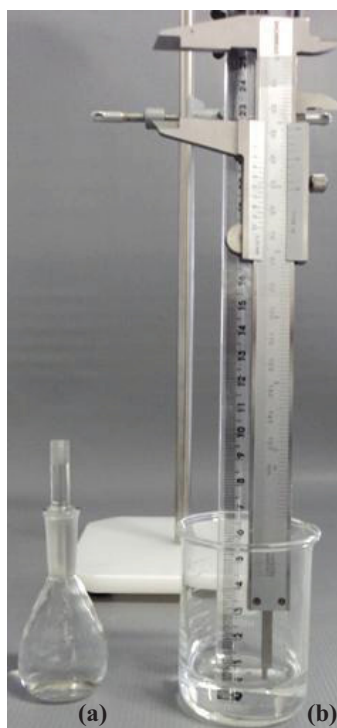
Fig. 3 – Instrumentos de medida para (a) determinação da densidade e (b) elevação capilar.
