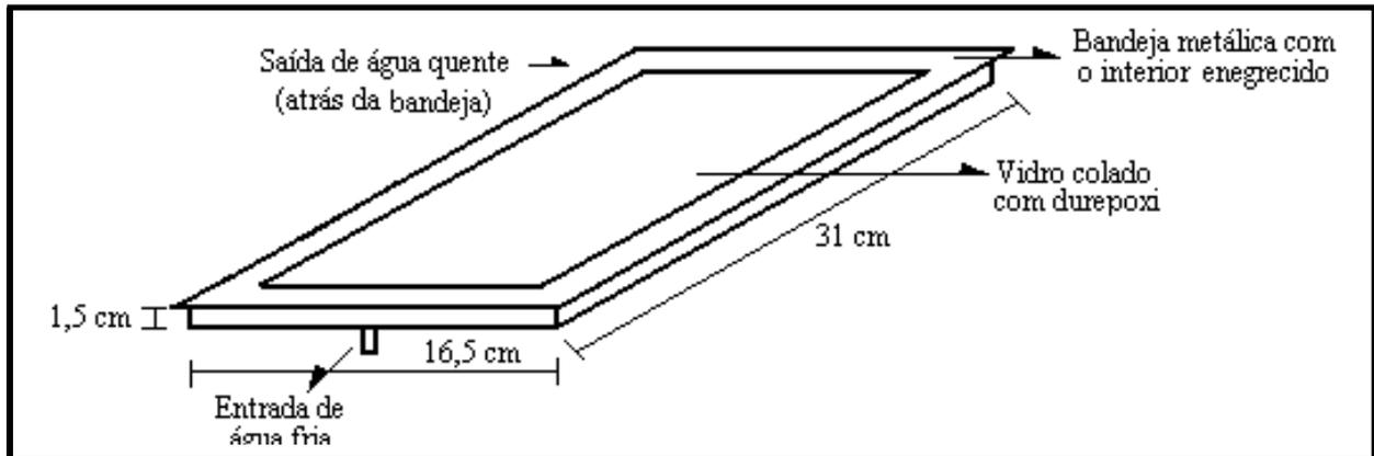
*Fig. 1 – Esquema do coletor*
