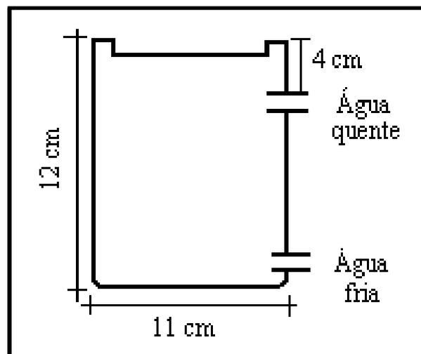
*Fig. 2 – Esquema do reservatório*
