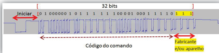
Fig. 7 – Decodificação da frase binária associada ao sinal proveniente de uma tecla do controle remoto
