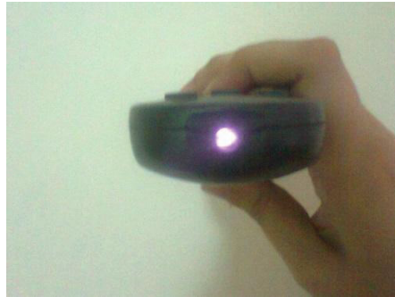
Fig. 2 – Observação da Radiação Infravermelha através de uma câmera fotográfica.
