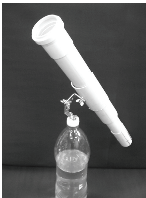
Foto 4 - Montagem completa da luneta apoiada em seu “berço” e este preso no suporte do trilho de cortina.
