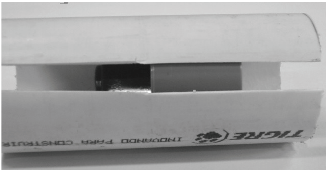
Foto 2 - Mostra o monóculo inserido na bucha de redução e esta dentro do tubo H. Do lado esquerdo da figura pode-se ver a distância entre a ocular do monóculo e a extremidade esquerda do tubo H.
