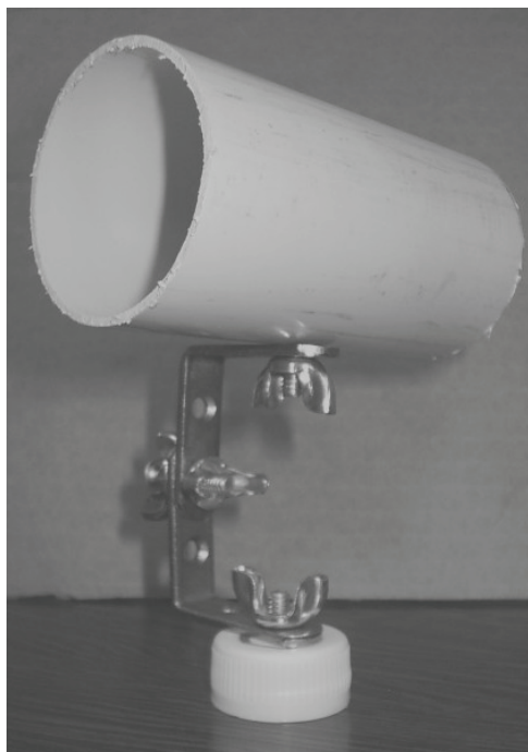
Foto 3 - Detalhe do tripé com a tampinha de garrafa PET, dois suportes de cortina pequenos e sobre eles o “berço” da luneta, pois esta será encaixada neste tubo de pvc o qual tem um corte longitudinal na sua parte superior, não visível na foto.
