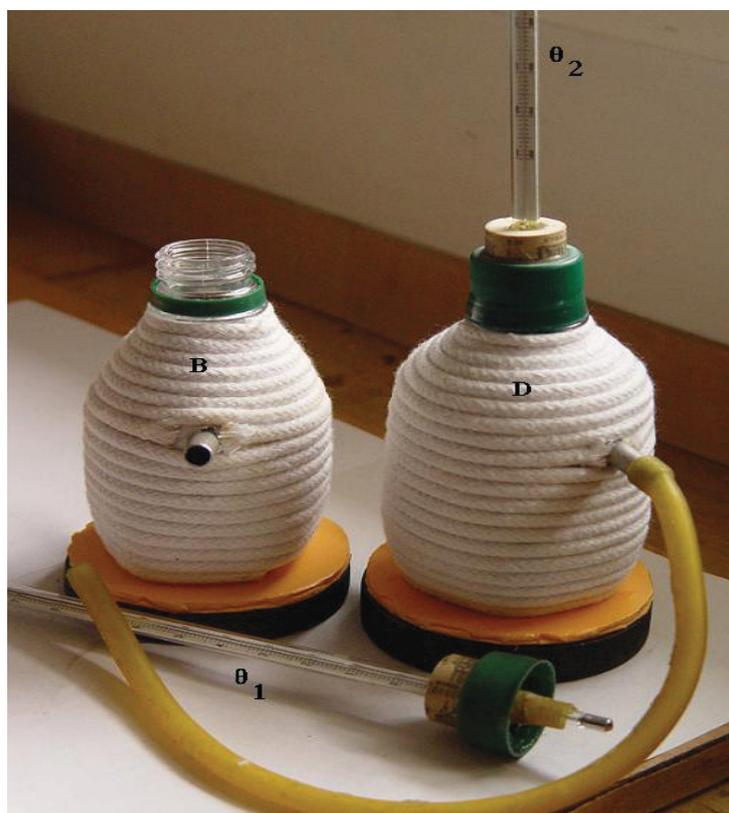
*Fig. 3 - As garrafas de refrigerantes, com suas tampas vazadas para a passagem dos seus respectivos termômetros, nomeadas como B e D na Fig. 1, foram envolvidas por papel alumínio e fios de algodão para evitar ao máximo as perdas de calor.*
