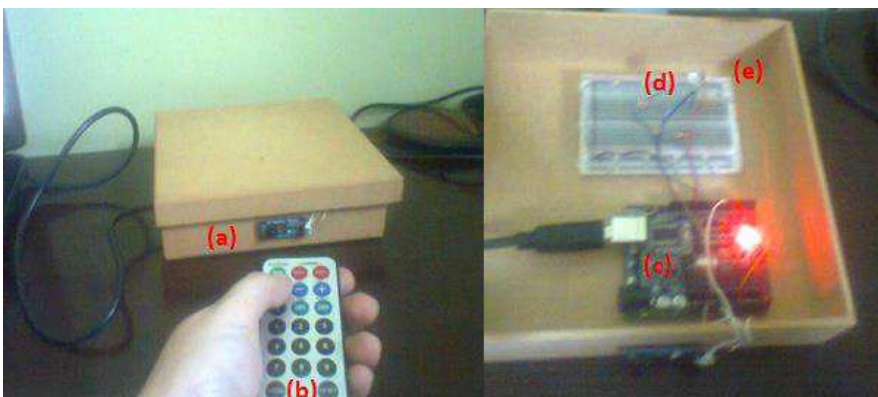
Fig. 10 – Montagem final do nosso projeto, lado externo (lado esquerdo) e lado interno (lado direito). Sendo os componentes: (a) Receptor IR, (b) Controle Remoto IR, (c) Arduino, (d) LED RGB e (e) LDR.
