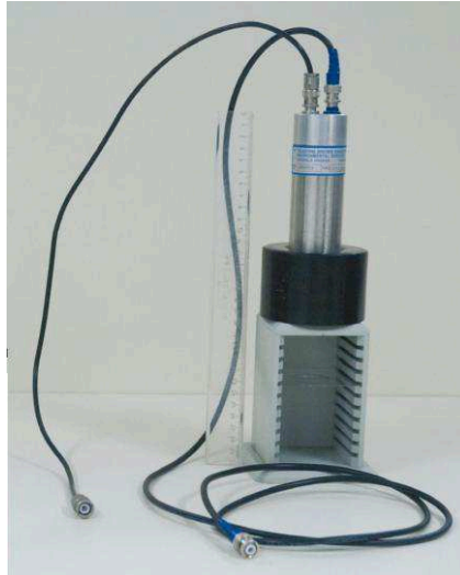
Fig. 2 – Detector de um espectrômetro de fótons. O conjunto cristal+fototubo fica dentro do invólucro de alumínio. Na parte superior encontram-se os conectores para o cabo de alta tensão e para o cabo que transmite o pulso gerado pelo evento do fototubo ao amplificador/analizador multicanal (não mostrado na imagem). O conjunto está sobre um suporte com prateleiras para posicionamento das fontes radioativas.
