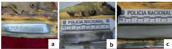
Figura 1. Ataque químico para la restauración de las marcas borradas, prueba (i) carrocería, marcación en taco, borrado con pulidora. a) Marca original KL1MJ61025C062044, b) resultado del tratamiento de borrado, c) revelado de la marca original.
