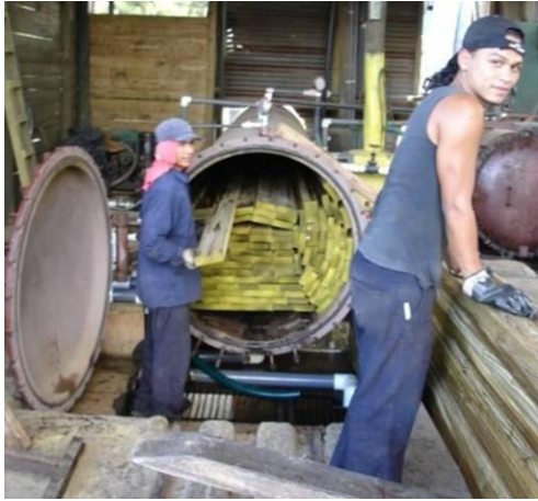
Planta de tratamiento utilizada para preservar la madera con el método de presión. (Fotografía: R. Moya. Instituto Tecnológico de Costa Rica).
