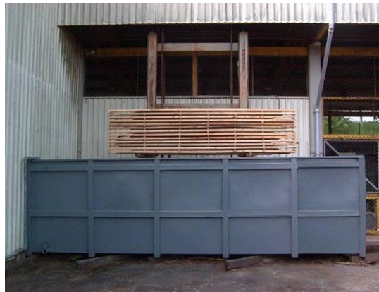
Tanque para el tratamiento de madera por el método de inmersión-difusión. (Fotografía: R. Moya. Instituto Tecnológico de Costa Rica).
