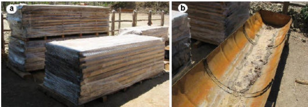
Figura 1. Madera apilada y cubierta por plástico de paletizar (a) y tanque de preservación construido para la preservación con el método inmersión-difusión (b).
