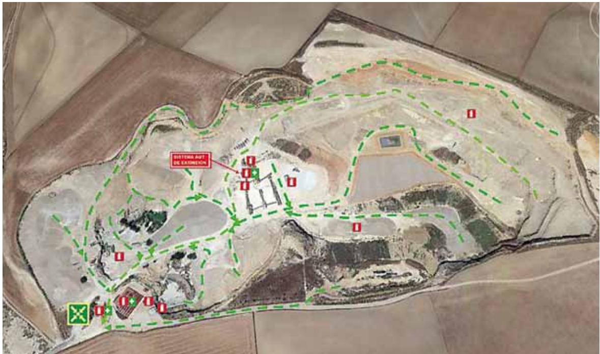
Señalización de vías de evacuación, primeros auxilios y sistemas de extinción de incendios
