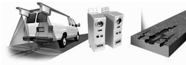
(d) Laser Crack Measurement System (LCMS)
