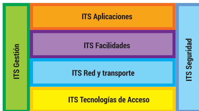
Figura 3. Arquitectura de referencia de estaciones ITS.
