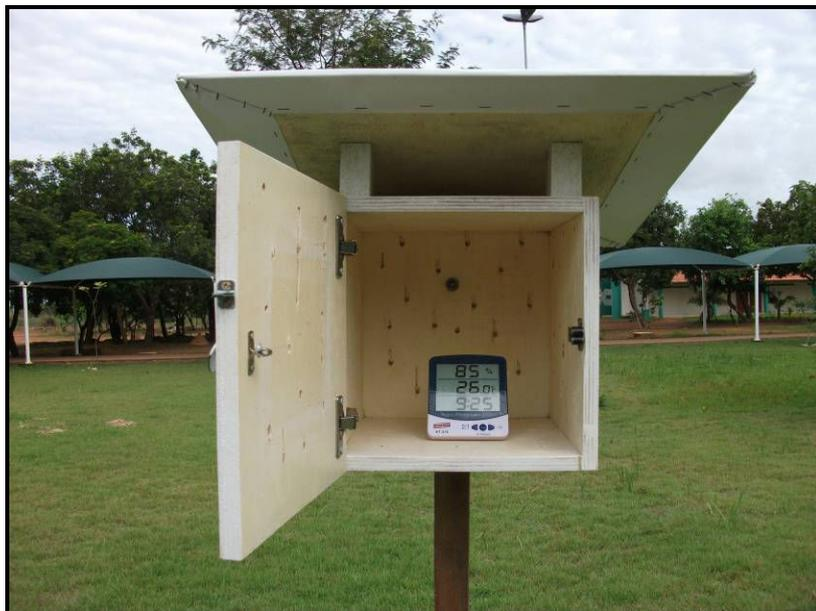
Figura 2. Modelo do termohigrômetro digital e do abrigo utilizados na pesquisa (P. H. P. Pinto, 2010).
