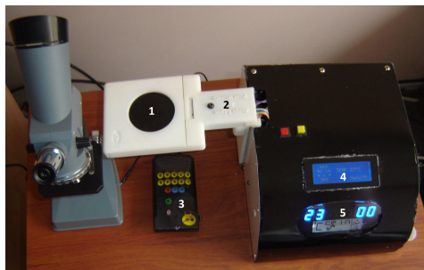
Figura 15: Prototipo final ensamblado. 1)Porta-Petri 2)Brazo mecánico 3)Control remoto 4)LCD 5)Indicadores.
