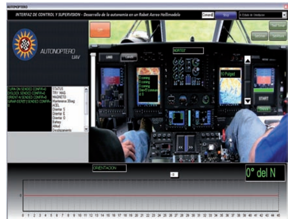
Fig. 6. INTERFAZ GRÁFICA EN DELPHI, ENVIÓ Y RECEPCIÓN DE DATOS POR BLUETOOTH AL HELIMODELO (AUTORES)
