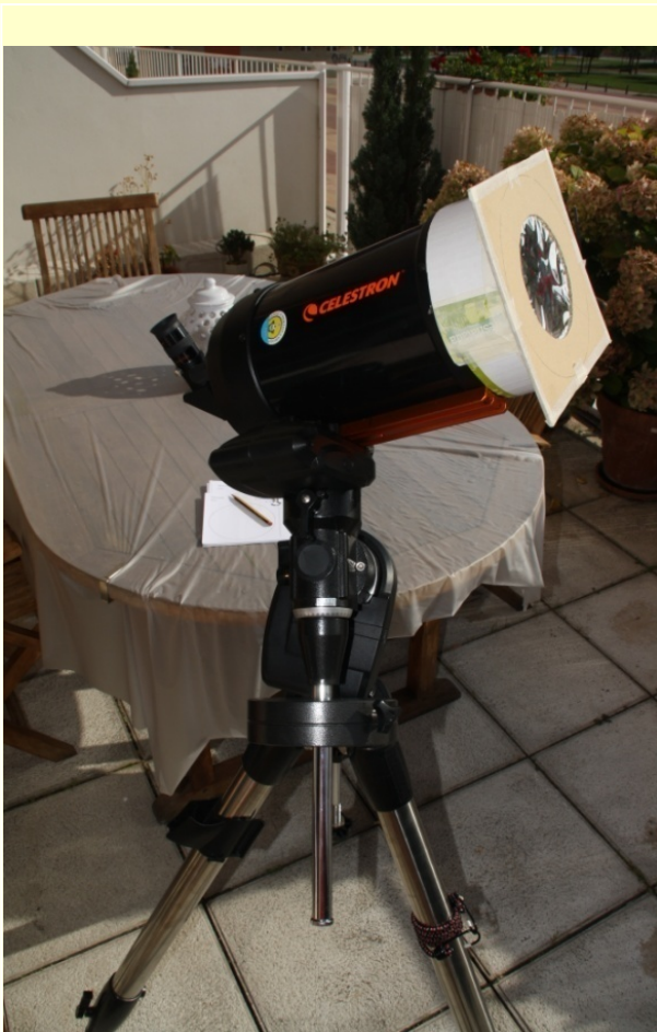
Fig. 6. Catadióptrico, es un tipo de telescopio llamado Schmidt-Cassegrain de 150 mm. (Fotografía de los autores).
