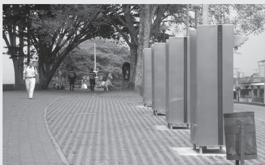
IMAGEN 1: Módulos de venta tipo A instalados en la ciudad de Manizales, cada uno de ellos tiene las siguientes dimensiones: 0.90mts. de ancho y 0.60mts. de profundidad; todos los módulos son en acero inoxidable e incluyen banca, basurero y una pequeña bodega.
