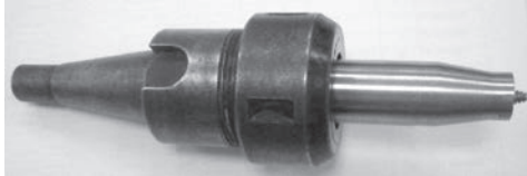
Figura 10. Herramienta de pin cónico roscado con hombro liso ensayada en portaherramientas
