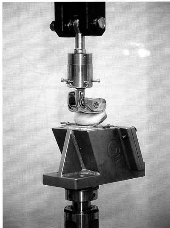
Figura 2. Ensayo a fatiga de una prótesis de rodilla.
