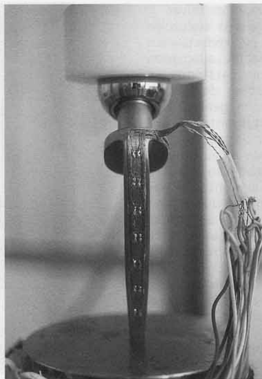
Figura 3. Prótesis de cadera instrumentada con galgas extensométricas para evaluar el modo de transferencia de cargas.
