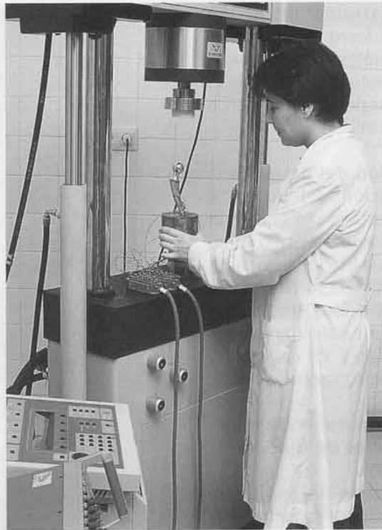
Figura 2. Montaje de una prótesis de cadera en la máquina de ensayos para evaluar la rigidez y resistencia del vástago.
