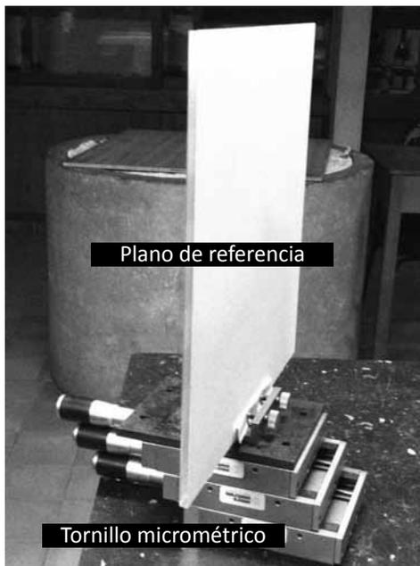
Fig. 6 Sistema de calibración experimental
