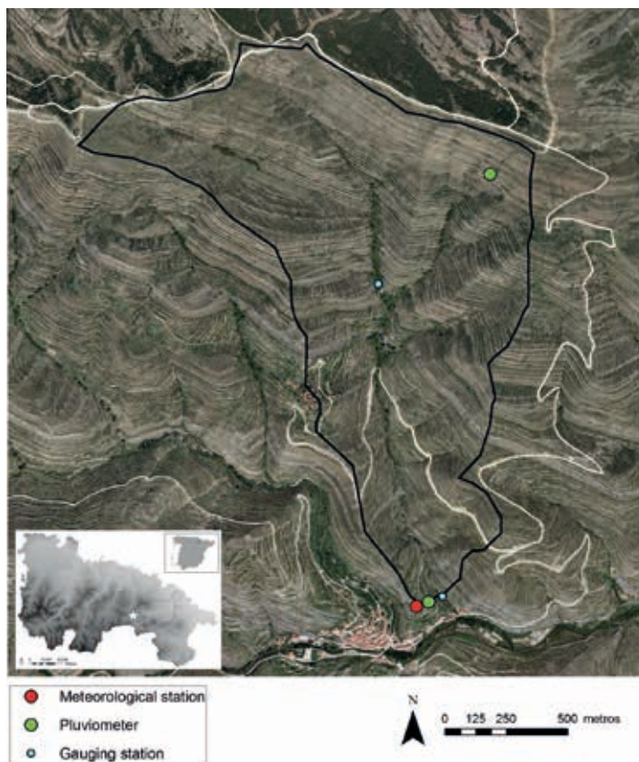
Figura 1. Dispositivo experimental en la cuenca "San Vicente de Munilla".
