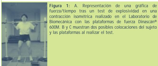
Figura 1: A. Representación de una gráfica de fuerza/tiempo tras un test de explosividad en una contracción isométrica realizado en el Laboratorio de Biomecánica con las plataformas de fuerza Dinascán® 600M. B y C muestran dos posibles colocaciones del sujeto y las plataformas al realizar el test.
