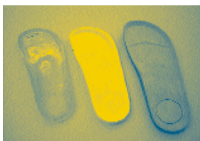
Figura 4. Muestra de prototipos obtenidos mediante técnicas de Ingeniería Inversa y Prototipado Rápido a partir de una planta inicial de corcho caucho de la talla 42 (derecha), y escalados a una 38. Los procesos utilizados fueron estereolitografía y Sinterización Selectiva por Láser (izquierda y centro de la imagen respectivamente).
